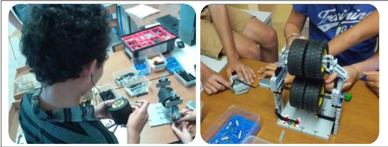
L'idée suivante est de projeter les pièces avec force sur une paroi grâce à des moteurs qui font tourner des roues. Avec le choc, les pièces doivent se séparer.
