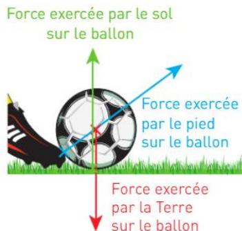
Pour représenter un vecteur force sur un schéma, il faut définir une échelle mettant en relation la valeur en Newton (N) à sa longueur en centimètres (cm).
